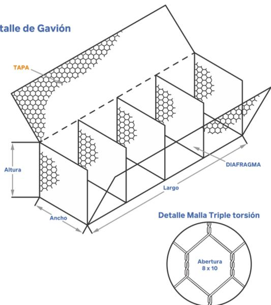
**NORMA DE FABRICACIÓN** NMX-B-085-CANACERO-2005
